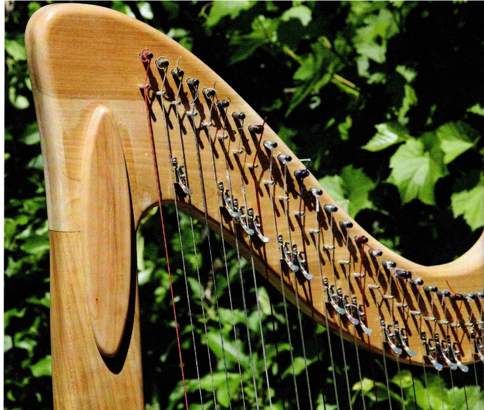
Afb. 13: De versterkte verbinding tussen hals en pilaar
