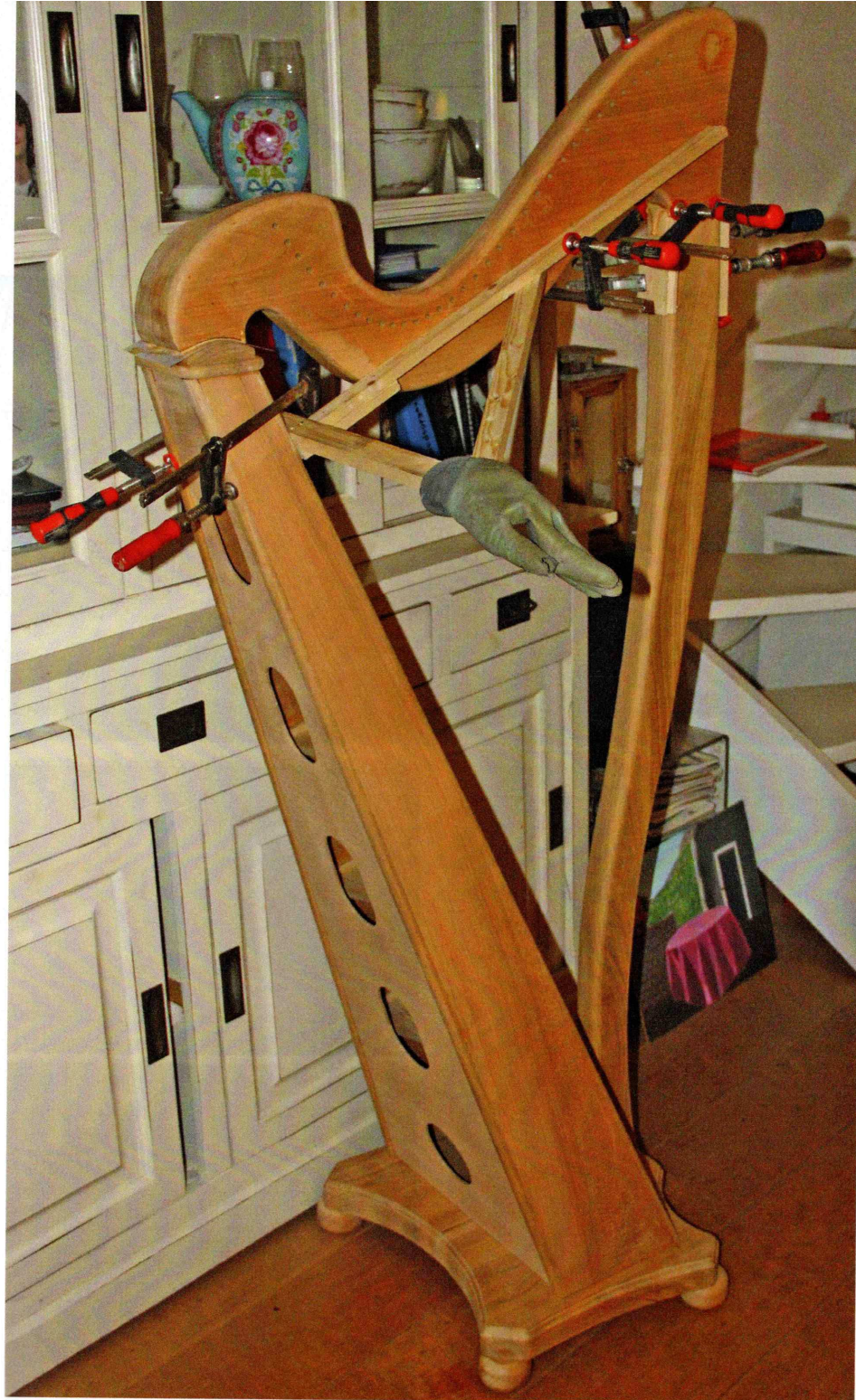
Afb. 10: Het lijmen van de hals aan de pilaar
